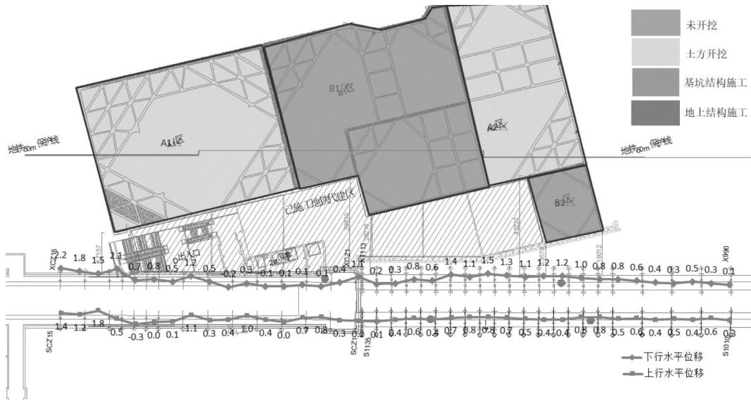
图 7-4 环境保护对象（地铁车站及隧道）累计变形矢量图
